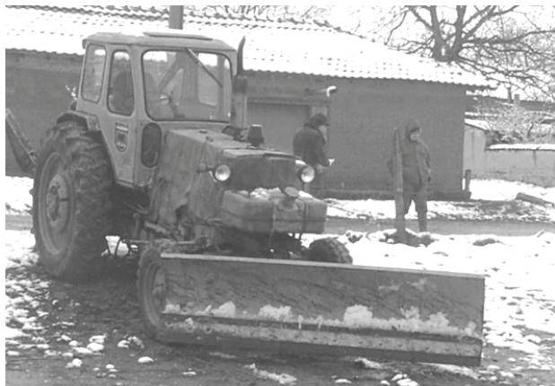
Трактор ЮМЗ, оборудван с гребло за изриване на сняг
